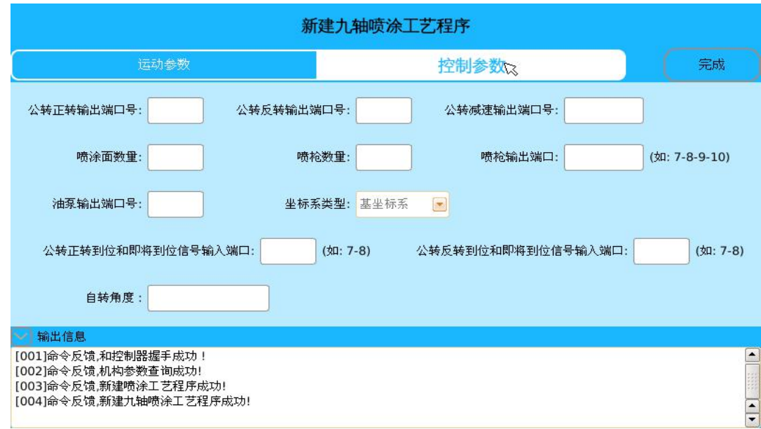
图4.23 “九轴喷涂工艺”控制参数
